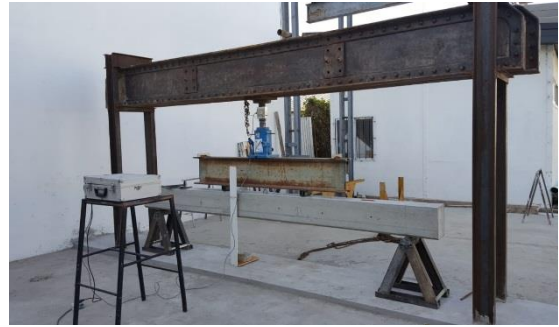
Figura 1. Viga de hormigón armado preparada para el ensayo de carga.
